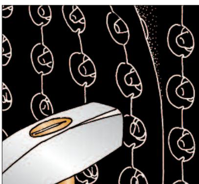
↑ Assemblage unique : les nopés et contre-nopés sont rivetés aux recouvrements en fin de rouleau par de simples coups de marteau. (Brevet européen).
